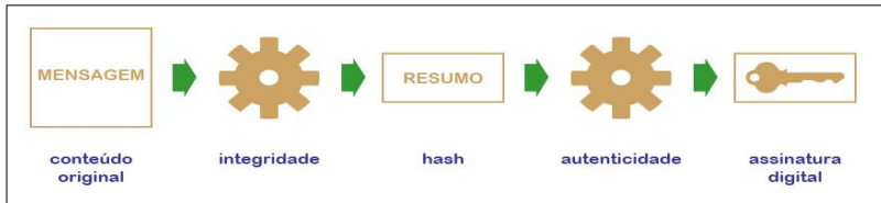
Figura 2 - Ilustração do mecanismo de assinatura digital
